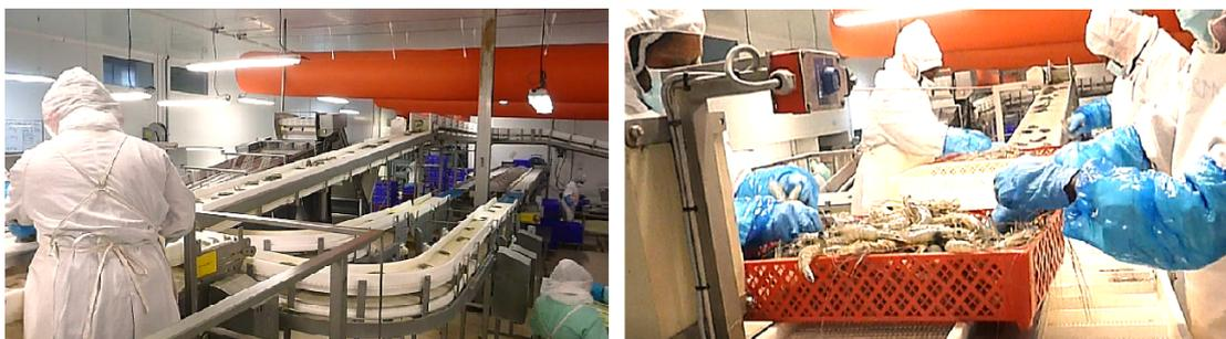
**Fig. 4.25** Tri des crevettes selon les défauts visibles
