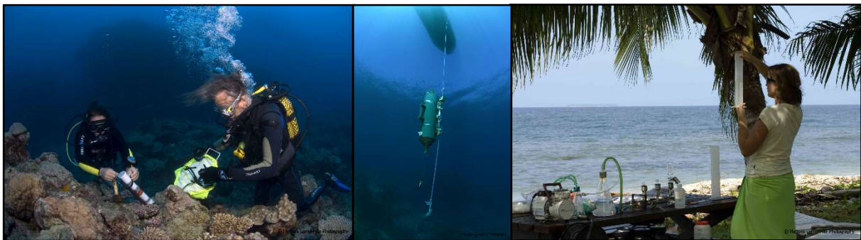
Figure XIII-1. Triptyque du SPHYNx. (a) Pose d'un capteur Température / Pression; (b) Descente d'une bouteille Niskin pour collecter un échantillon d'eau ; (c) Filtration des échantillons.
