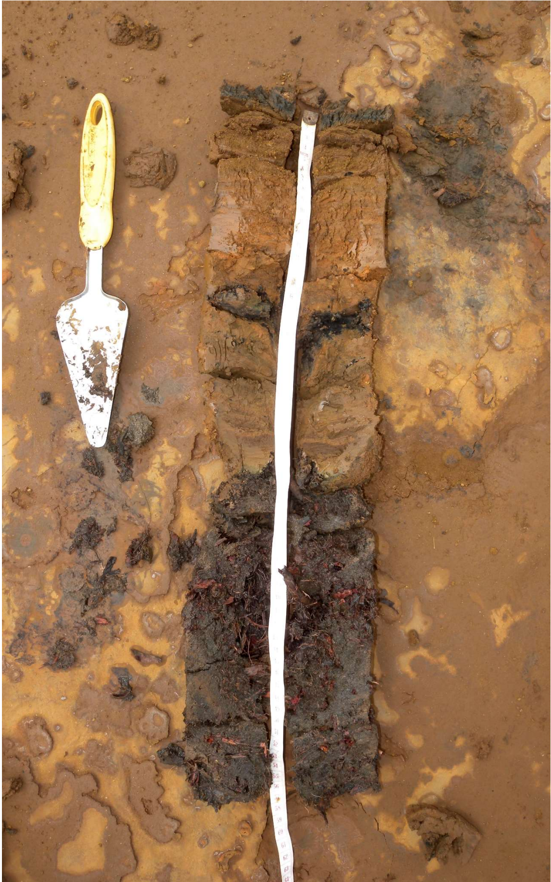
Photographie VI-3. Carotte réalisée dans une tanne impactée par l'activité minière.
