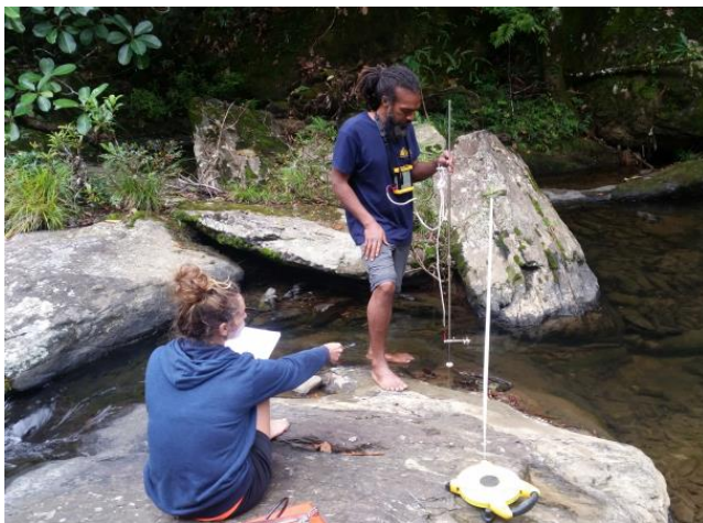
Figure 53 - Jaugeage en période d'étiage effectué par Jean-Pierre Poigoune (CAAM). Nordan Bernast (SDE-DAVAR) le 28/08/2019
