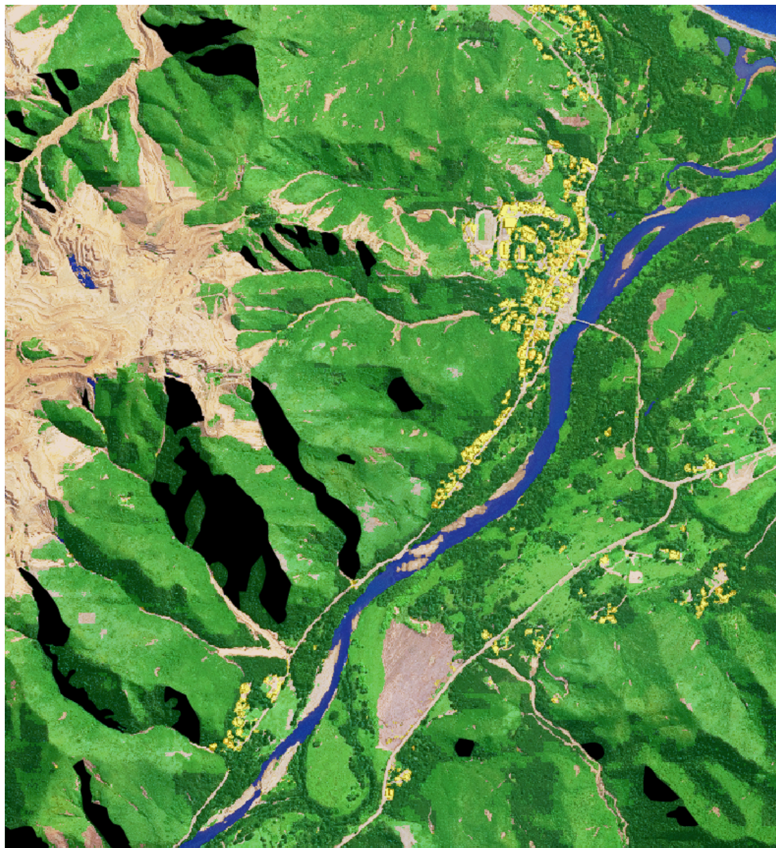
FIGURE 3.14 – Résultats de l'application de l'architecture DeepLab sur l'image SPOT 6 de la commune de Thio pour la tâche de classification de la couverture du sol dont la nomenclature est présentée Tableau 3.1.
