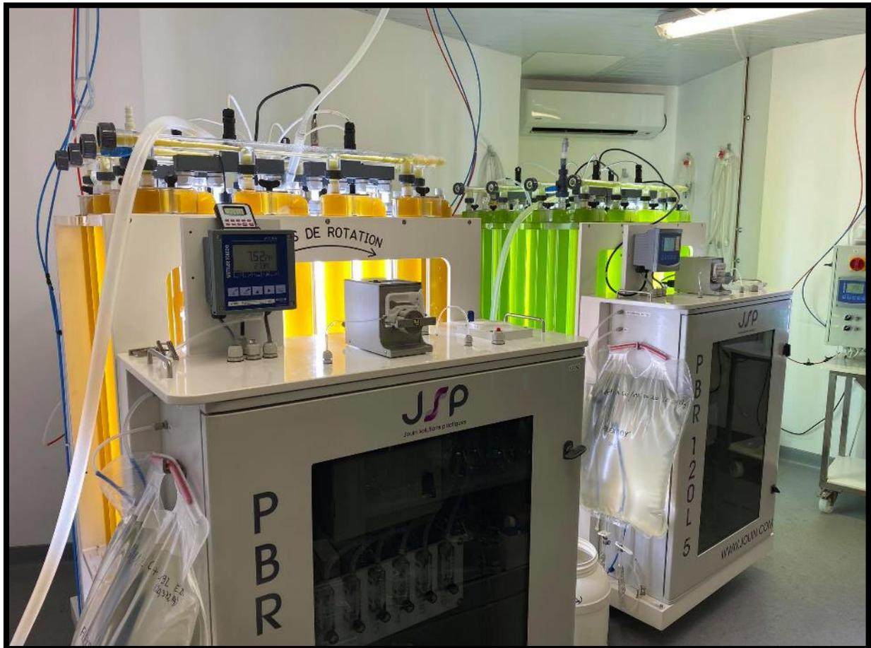
**Figure 2-20.** Photographie des deux photo-bioréacteurs de 120 l en cours de culture de *T-Isochrysis* sp. (gauche) et de *Dunalliella* sp. (droite). Ces appareils ont été mis en place dans les locaux de l'Adecal Technopole (© T. Hue).
