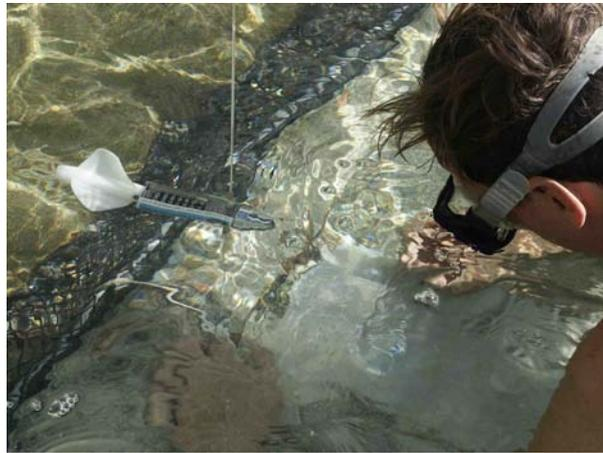
Figure 3-4. Relevé du courant moyen enregistré par un débitmètre, attaché directement au cadre du filet. Le débitmètre est positionné à équidistance des côtés (à 1 m des bordures gauche et droite du cadre) et à 20 cm de la dalle corallienne, de manière à enregistrer le courant même lorsque la hauteur d'eau est faible tout en évitant une partie des turbulences formées par le courant sur le substrat.
