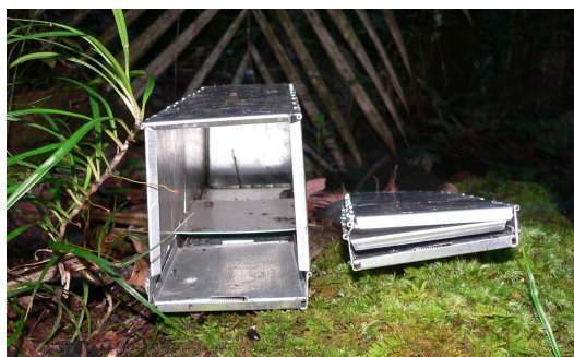
Figure 5. Pièges Sherman ouvert (à gauche) et replié pour le transport (à droite).
