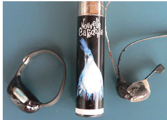
Figure 58. A gauche un émetteur avec l'antenne incluse dans le collier, à droite un émetteur avec antenne externe.
