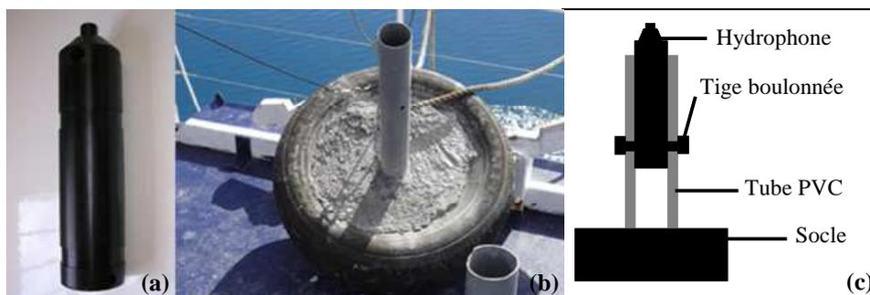
Fig. 11. Hydrophone VR2 (a), système d’ancrage sur le substrat (b) et schéma du dispositif monté (c).
