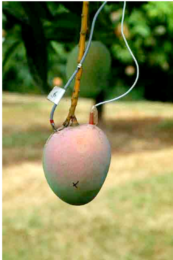
Photo 2. Sondes d'enregistrement de température interne dans le cv. Kensington
