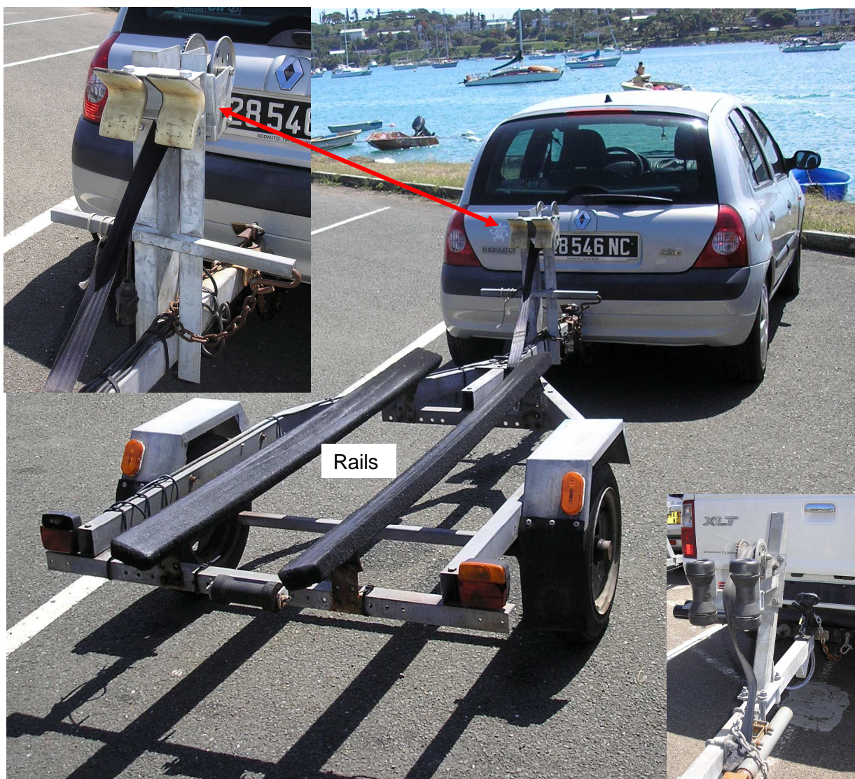
Photo 2 : Caractéristiques d'une remorque pour VNM (jet-ski)
