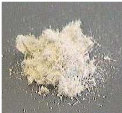
Photographie 15 - Fibres d'amiante – source INRS
