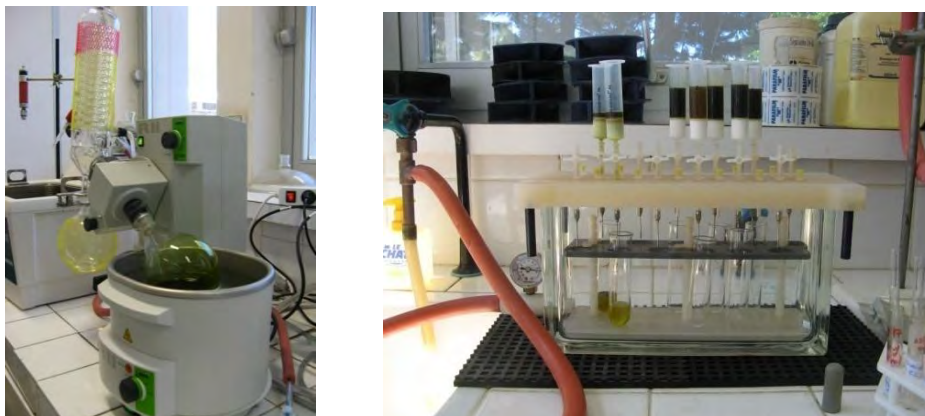
Figure 68. Evaporation sous pression réduite et filtration sur gel de polyamide.
