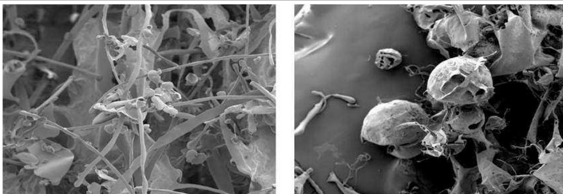
Figure 35 : Observation par MEB de l'EPS NC470 après mise en contact avec le sel de nickel. Visualisation de structures sphériques chargées en nickel (grossissement x800)
