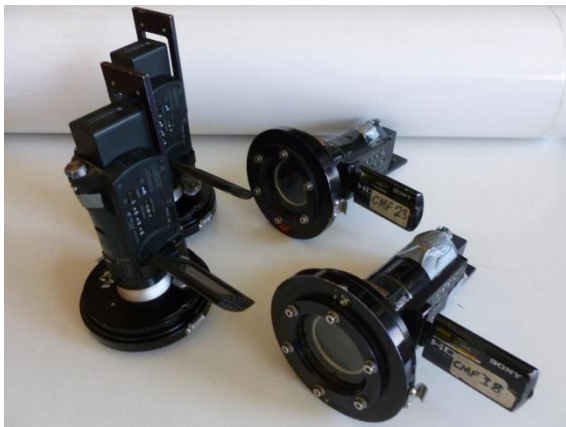
Fig. 2.6 Caméras Sony HDR CX-7 /CX-12 utilisées dans le dispositif S-BRUVS ( Stereo Baited Remote Underwater Video System ). Les caméras sont fixées sur un hublot permettant de les maintenir complètement immobiles et garantissant le maintien de leur calibration.
