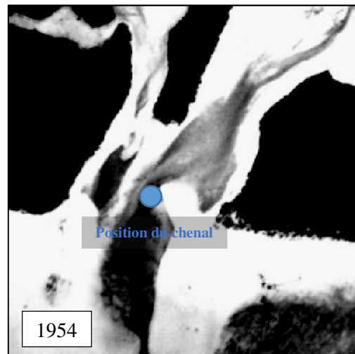
Figure 112 : La passe de Hnyimèk avant (1943) et après (1954) le passage du cyclone (1951). Modifications morphologiques importantes : disparition de la flèche sableuse (1,96 ha) et reconfiguration du chenal lagon-lagune.
