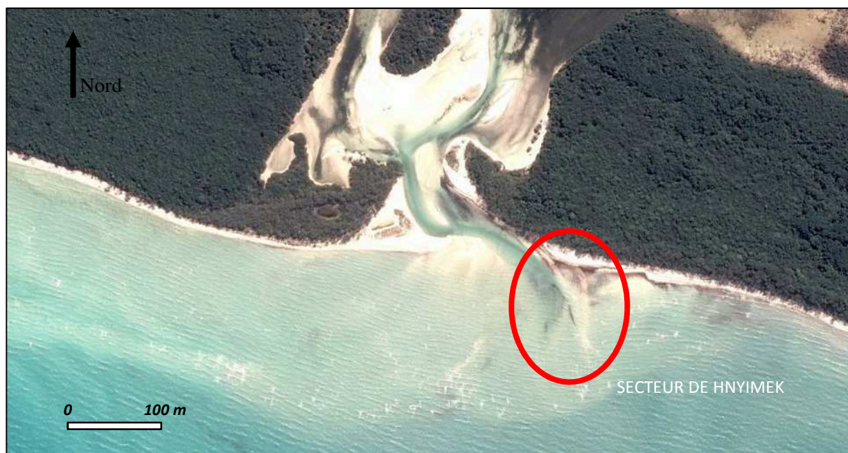
Figure 114 : Limite de cellule hydrosédimentaire mobile, matérialisée par la présence d'une ride sableuse se développant de manière oblique vers l'intérieur du lagon (image sat : googleearth, 2016, mise à jour 2018).
