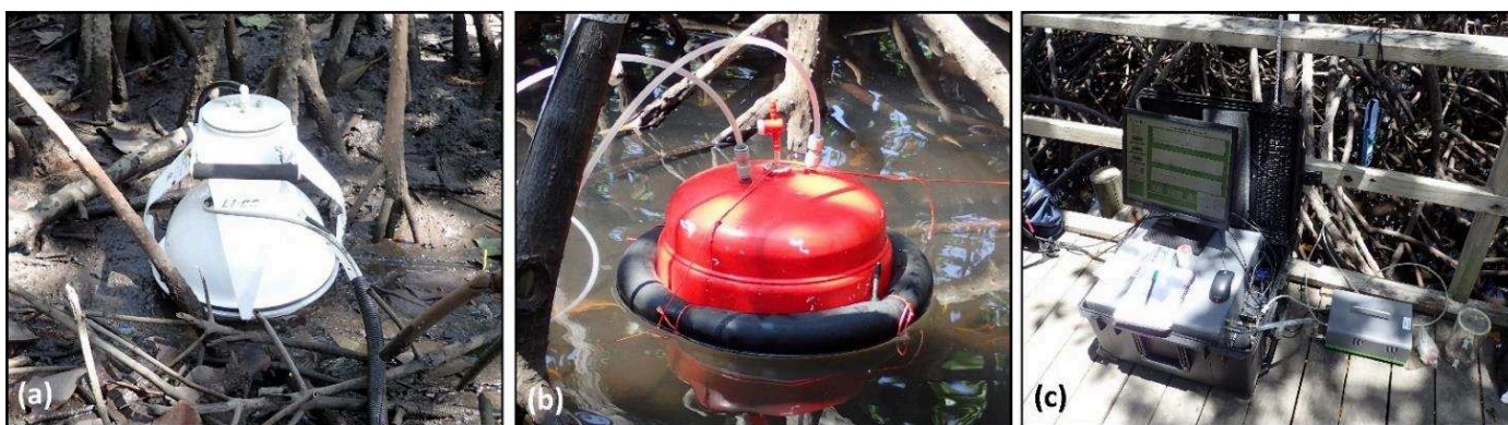
Figure III-1: Photographies (a) d'une chambre d'incubation opaque utilisée à marée basse, (b) d'une chambre d'incubation flottante utilisée à marée haute, et (c) de l'analyseur CRDS utilisé pour mesurer les émissions.
